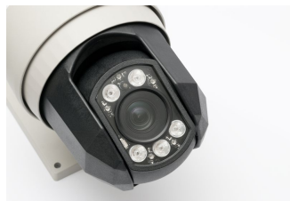
Iluminator IR 100m, sincronizat cu modulul optic
